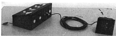
Mesa de luz adaptada com dimmer para uso de lâmpada comum
